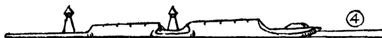
Pentures à trois branches avec garniture intermédiaire de petits fers. 4: Profil de la penture n° 3
